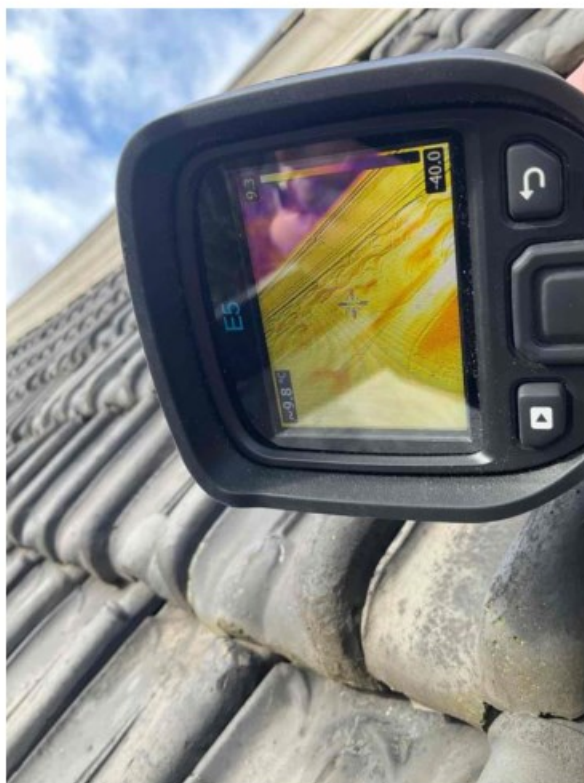
Thermografische beelden laten geen verhoogde warmte waardes zien, ook niet onder de geopende pannen en bekeken ruimtes.
