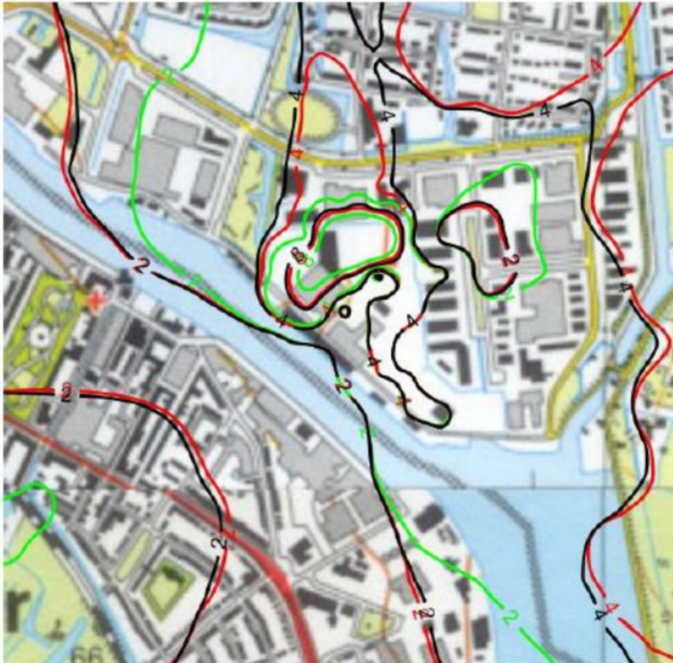
Fig. 3.7.1- 2: 98 percentielconcentraties van 2, 4 en 8 OU_E/m^3 situatie dichtbij - Zwarte contouren: situatie voor plaatsing BBT - Rode contouren: situatie na plaatsing BBT gaswasser - Groen contouren: situatie na plaatsing van een vorm van naverbranding
